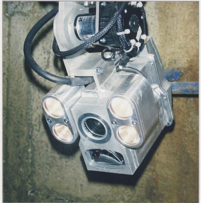
Das neue computergestützte Schachtinspektions-Robotersystem Cusi ist extrem leicht und somit gut transportier- und handelbar.
