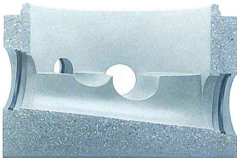
Der Schnitt durch ein Betonschachtunterteil zeigt den monolithischen Aufbau des Bauwerks: Individuell ausgeformt, beständig, mit integrierten Dichtungen ausgestattet.
