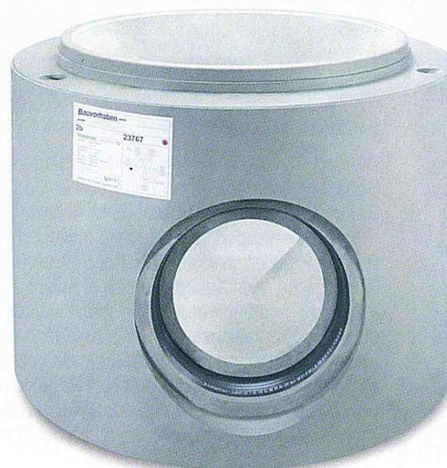
Die Vorteile individuell ausgeformter monolithischer Bauteile werden durch die Anwendung integrierter Dichtungen ideal ergänzt. Dabei wird in der Herstellung des Betonschachtunterteils die Dichtung bereits paßgenau eingesetzt und in einem Fertigungsschritt fest in den Bauteil eingegossen.
