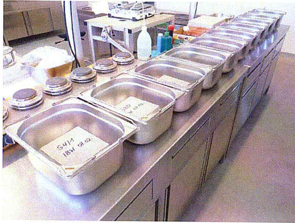
Bild 3: Anordnung aller Prüfkörper in Prüfbehältern
